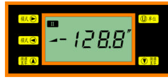
测量单位：秒(") 的状态显示
